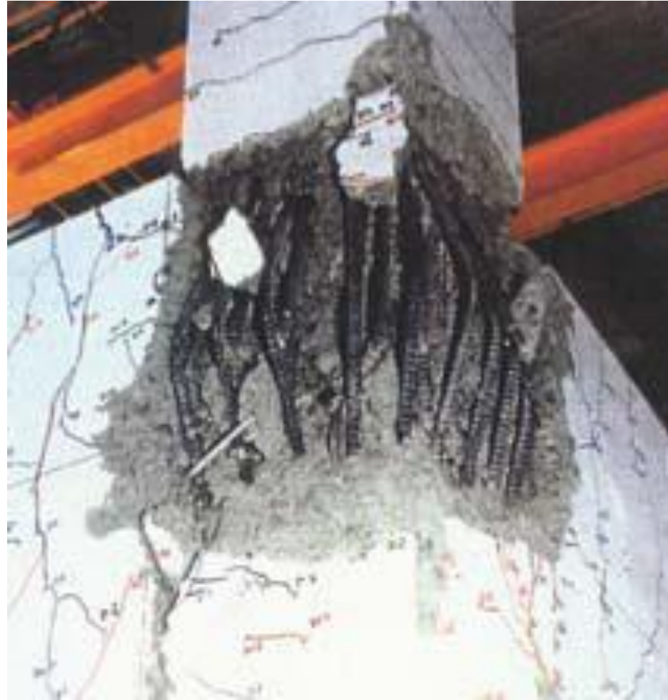
کمانش میلگردهای طولی ستون در ناحیه اتصال چراغ مشهدی سر انبساطی
